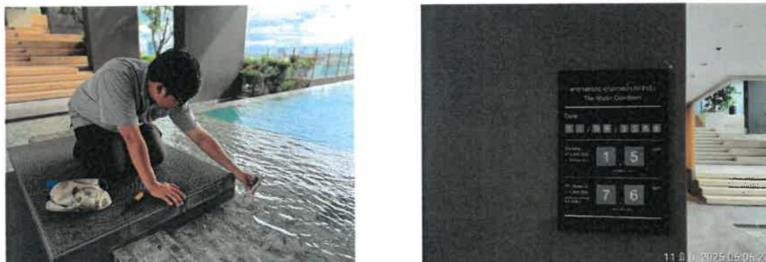
ภาพที่ 3.5.4-2 การตรวจวัด pH, \text{Cl}_2 สระว่ายน้ำ
